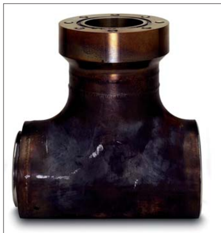
Bild 4: TEBO-Ventilunterteil nach äußerer Beflammung
