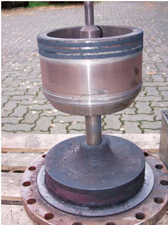
Bild 5: Parabolkegelspindel mit dem oberen Entlastungskolben nach der Demontage
