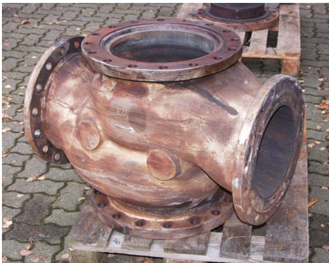
Bild 3: Regelarmatur nach 25 Jahren in einem Fernwärmenetz
