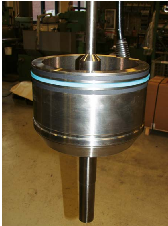
Bild 6: Neue Kegelspindel mit erneuerten Kolbenführungsringen und O-Glyd-Ring
