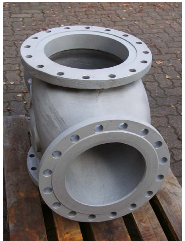
Bild 4: Nach der Reinigung und Nacharbeitung der Dicht- und Führungsflächen: Das Gehäuse ist neuwertig
