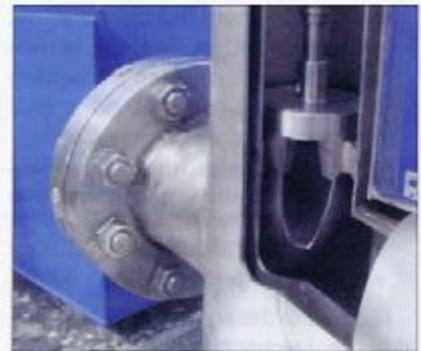
**Bild 5:** Neues doppelwandiges Stellventil DMV Typ 600 (Schnitt im Sitzbereich)
