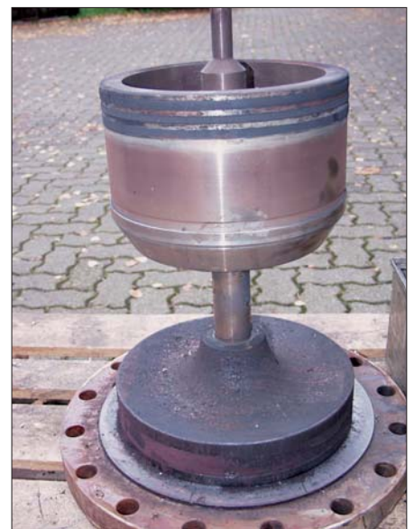
Bild 6: Parabolkegel mit dem oberen Entlastungskolben
