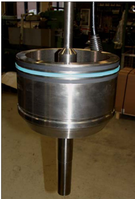
Bild 7: Neue Führungs- und Dichtringe Fig. 7: New guide and sealing rings
