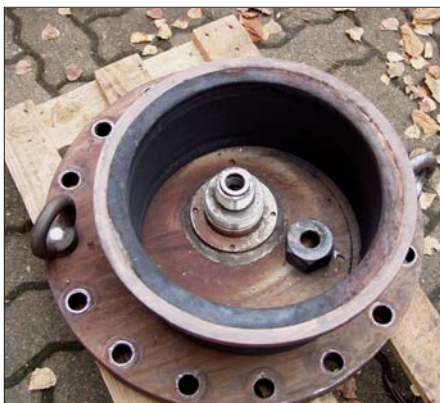
Bild 4: Oberer Deckel mit Stopfbuchse nach der Demontage
